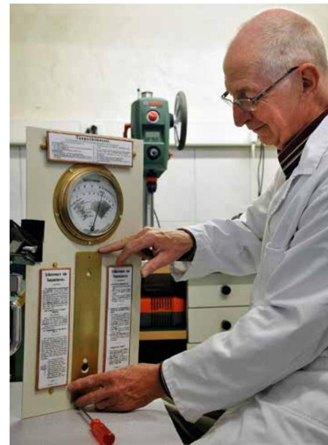
Alles wie neu: Karl Vögeli montiert die Messingplatte für das Quecksilberthermometer.
